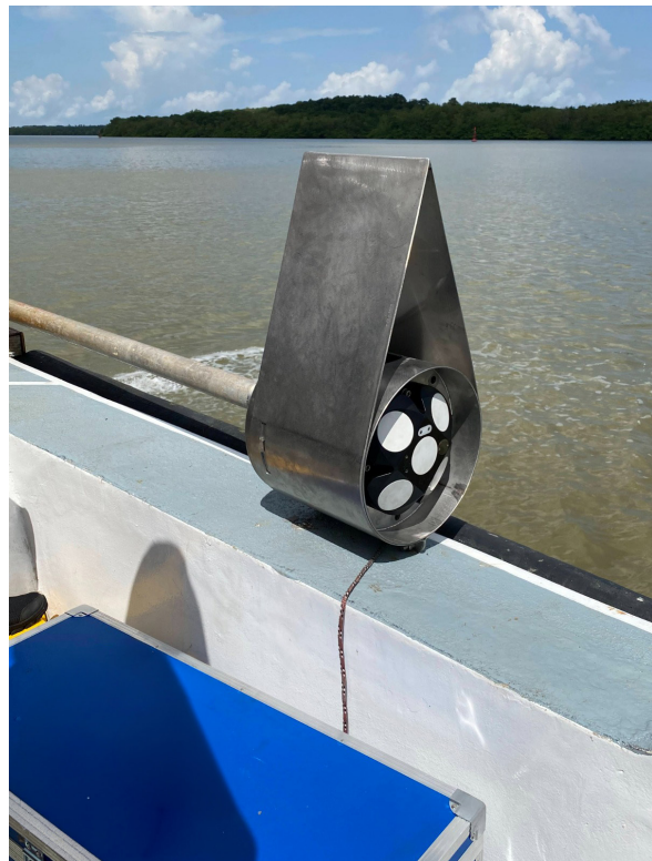
Aparelho ADCP que foi utilizado para medir a velocidade e direção das correntes
