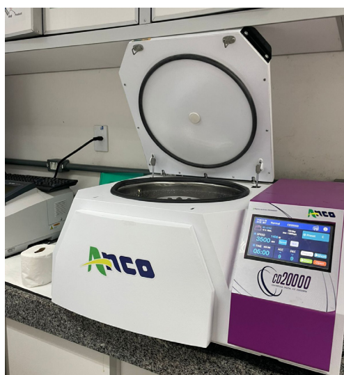
Centrífuga de alta rotação, adquirida com apoio da FAPEMA, utilizada no processo de purificação do catalisador \text{Al}_2\text{O}_3/\text{Nb}_2\text{O}_5
