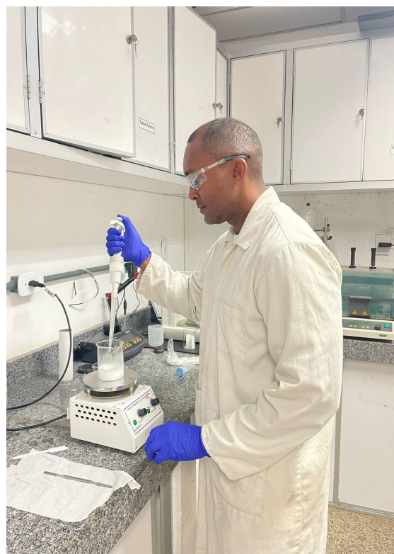
Processo de síntese do catalisador \text{Al}_2\text{O}_3/\text{Nb}_2\text{O}_5 em dimensões nanométricas, que será misturado ao breu branco para obtenção do combustível
