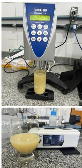
Procedimento para determinação da viscosidade
