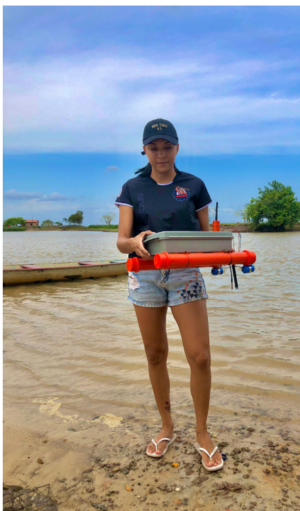
O Veículo Pilotado Remotamente é usado para mapear as profundidades e melhorar a navegação.
