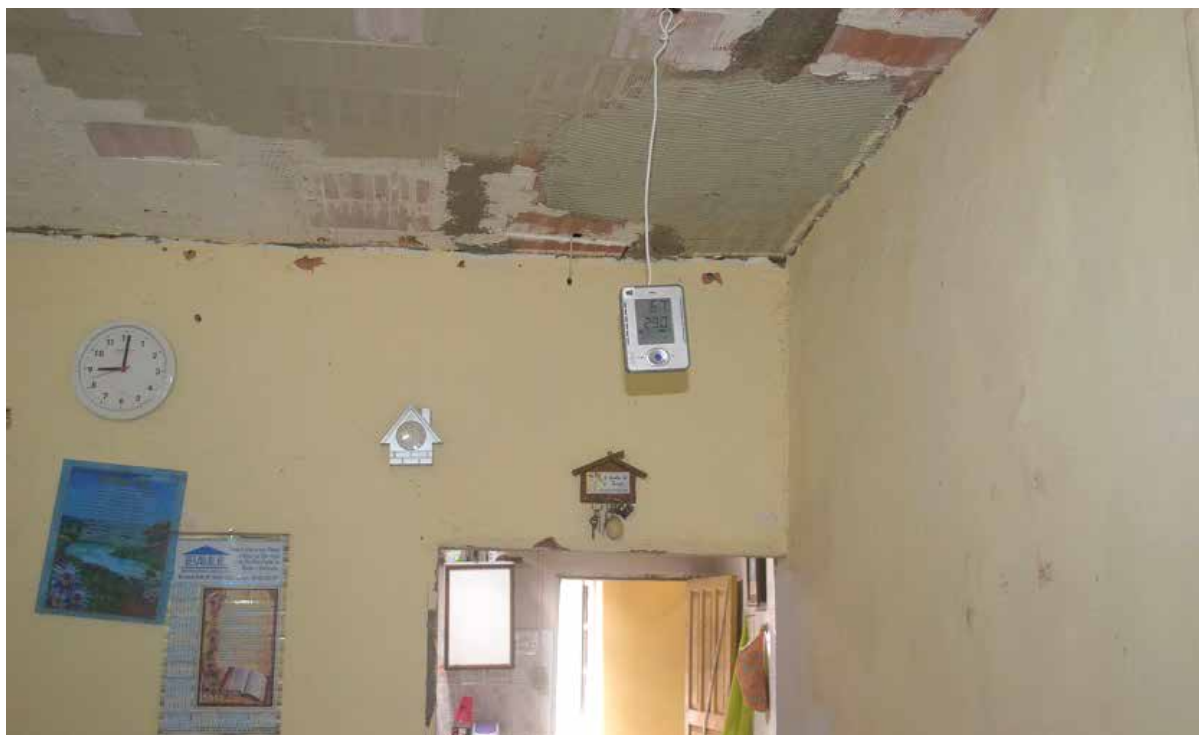
Medição da temperatura em ambientes atingidos pelo estudo
